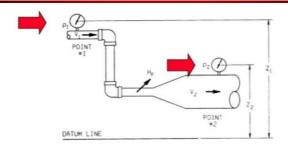
در یک سیستم سیال ماری و بدون اصطکاک، انرژی در نقاط مفتلف برابر است.
