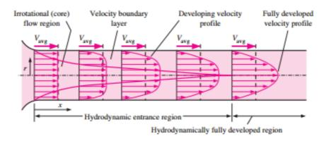
فاصله لازم برای پروفیل سرعت تا رسیدن به پروفیل توسعه یافته نسبت به پروفیل یکنواخت مقطع ورودی
