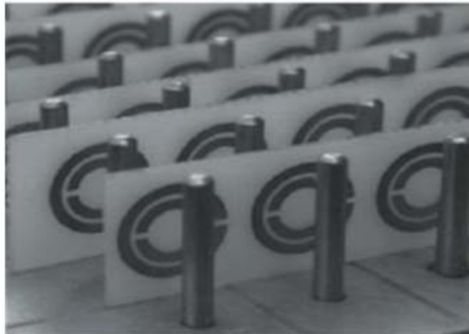
شکل ۱-۵: آرایه پیشنهادی برای مواد با ضریب شکست منفی.
