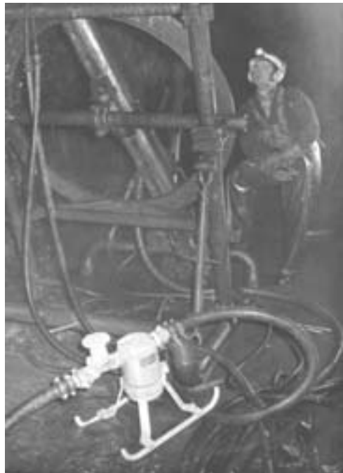
شکل ۶-۱۹ - منظره ی عمومی کاربرد شیلنگ های هوای فشرده در معادن زیرزمینی
