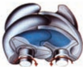
شکل ۱۰-۶- اصول کار کمپرسور پیچی
