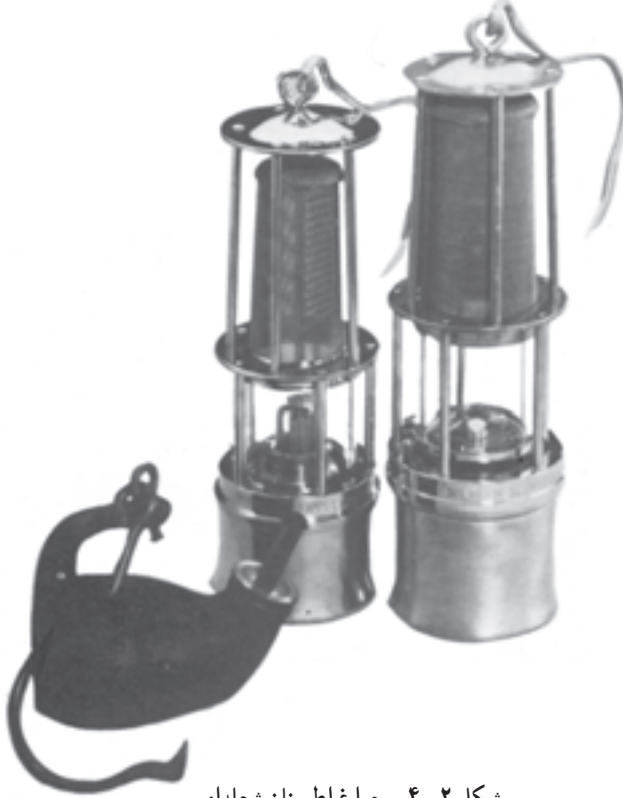
شکل ۲-۴- چراغ اطمینان شعله‌ای
