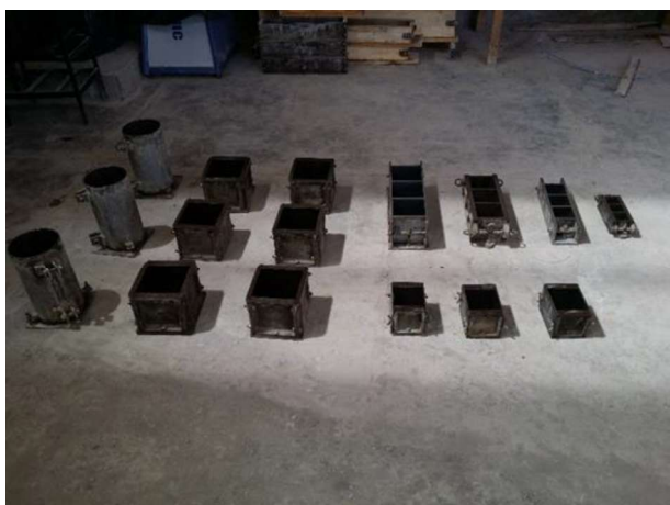
شکل ۳: آماده سازی قالب ها
