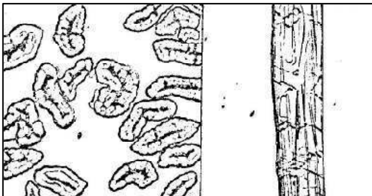
شکل ۲۵ مقطع عرضی و سطح طولی لیف رami
