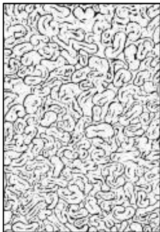
شکل ۱۵ سطح مقطع پنبه مرسریزه نشده
