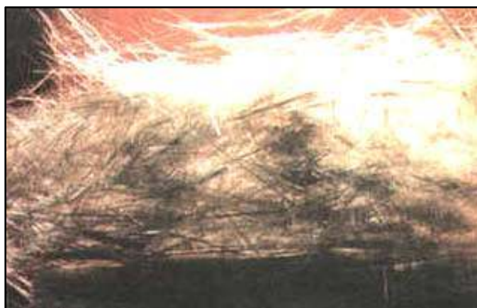
شکل ۲۹ الیاف آزبست یا پنبه نسوز
