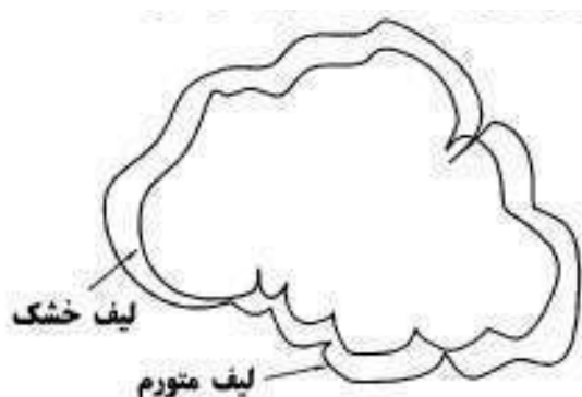
شکل ۹ مقایسه سطح مقطع لیف متورم شده و خشک
