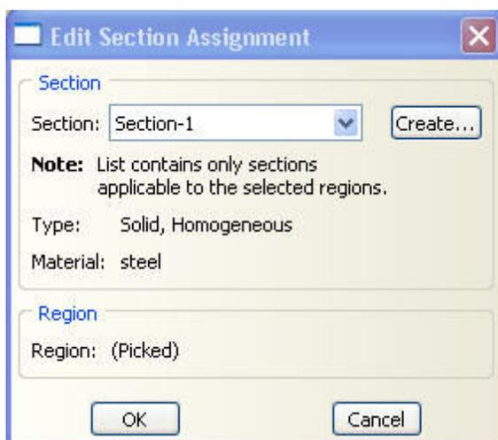
4- مرحله قرار دادن ماده تعریف شده به جسم که از مسیر زیر امتحان می کنیم. Assign>section بعد انتخاب جسم بر روی Done کلیک کنید. صفحه زیر باز می شود و بعد انتخاب section مورد نظر ok را انتخاب می کنیم.
