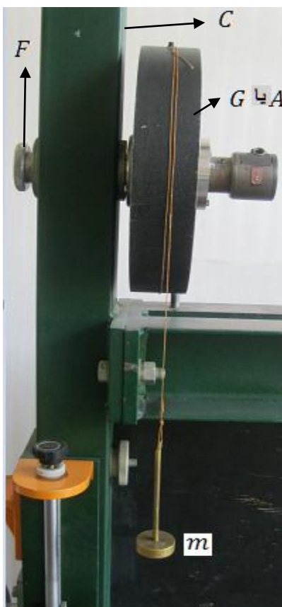
شکل ۴-۱-۴ چرخ طیار و چگونگی تعیین ممان اینرسی آن
