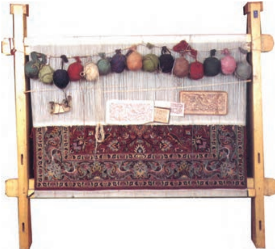
تصویر ۴-۱۲- دستگاه قالی‌بافی عمودی تبریزی
