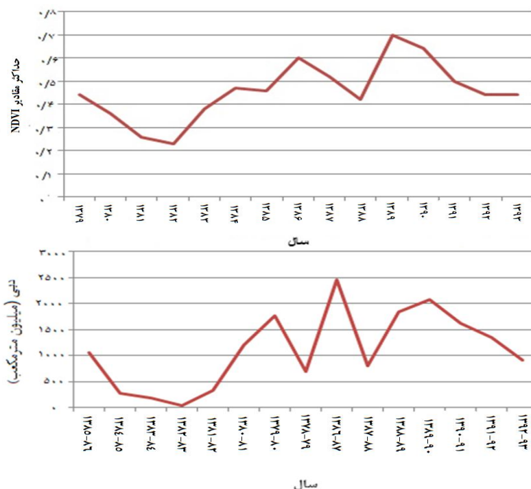
شکل 5. تغییرات حداکثر MODIS NDVI ماه فروردین در طول دوره آماری 1379-1393 (نمودار بالا) و تغییرات میانگین سالانه دبی (میلیون مترمکعب) رودخانه هیرمند در طول دوره آماری 1379-1393 (نمودار پایین)
