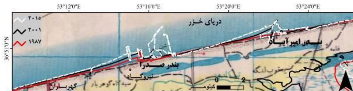
شکل ۴: استخراج تغییرات و جابجایی مکانی خط ساحلی طی بازه زمانی ۱۹۸۷-۲۰۱۵ با استفاده از تصاویر ماهواره Landsat و جانمایی آن بر روی نقشه توپوگرافی ۱:۲۵۰۰۰۰ برگ ساری مربوط به سال ۱۳۵۴ خورشیدی (۱۹۷۵ میلادی).
